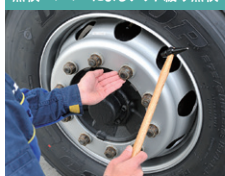
点検ハンマーによるナット緩み点検
