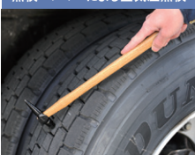
点検ハンマーによる空気圧点検
